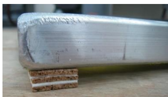
Figura 4. Ejemplo de separación con almohadilla de corcho.
