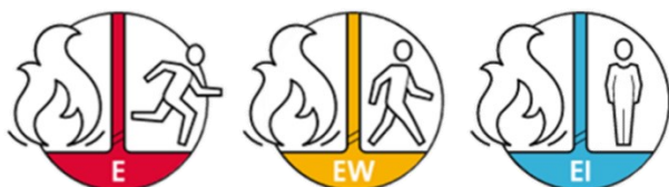
Figura 3. Niveles de resistencia al fuego
