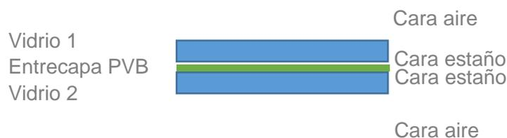
La detección de la cara aire/estaño se puede realizar mediante un chequeo de estaño o lámpara UV.
