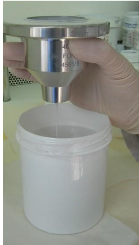
Ford Cup (no apto para viscosidad de 15Pa.s)
