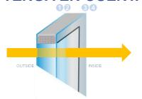
El doble acristalamiento se puede combinar con otras soluciones como: Control solar, baja emisividad (aislamiento térmico reforzado), control acústico, seguridad, entre otros.
